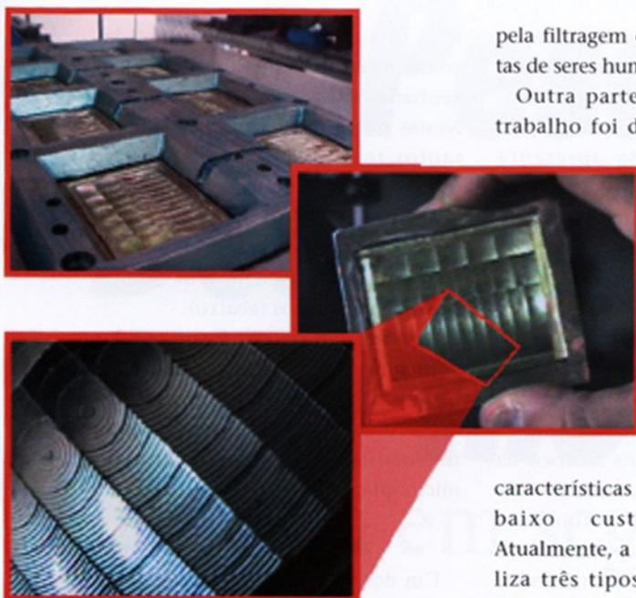
Figura 3 - acima: Molde metálico para a fabricação de lentes de Fresnel poliméricas em escala industrial; ao centro: Inserto de molde (48X60 mm); abaixo: Imagem ampliada do Inserto. Numa lente convencional os anéis são concêntricos; a distância entre duas ranhuras é de 0.5 mm.
