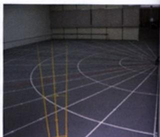
Figura 6 – Laboratório construído no departamento de projetos da empresa PPA para testes de desempenhos de sensores de movimento passivos, seguindo as instruções do protocolo IACSE (desenho à esquerda): quantificação da habilidade de detecção e sua susceptibilidade a falsos alarmes.
