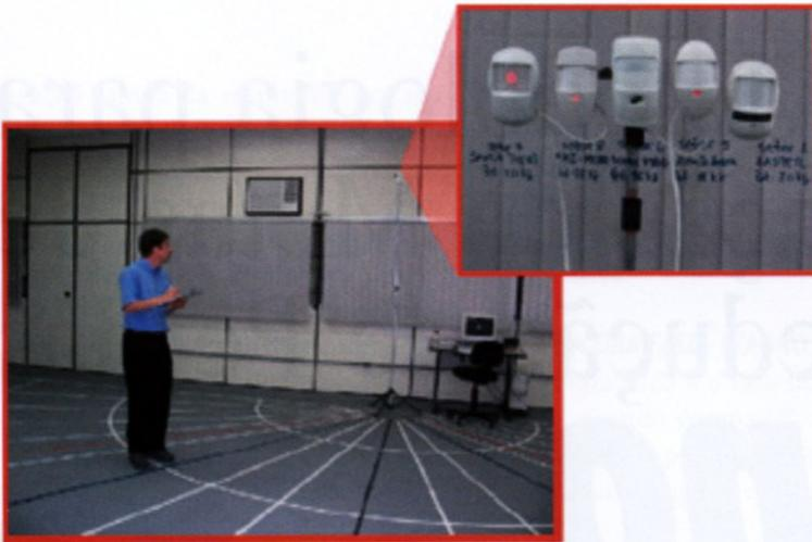
Figura 7 - Testes manuais de mapeamento do volume de monitoramento do sensor. À medida que uma pessoa percorre os arcos, o comportamento do sensor é monitorado visualmente: ao disparar, é feita uma marca no ponto onde a pessoa se encontra. Quando todos os arcos foram percorridos, a planilha de resultados apresenta-se como mostra a figura 8. À direita, o desenho esquemático das trajetórias a serem percorridas, segundo protocolo IACSE.
